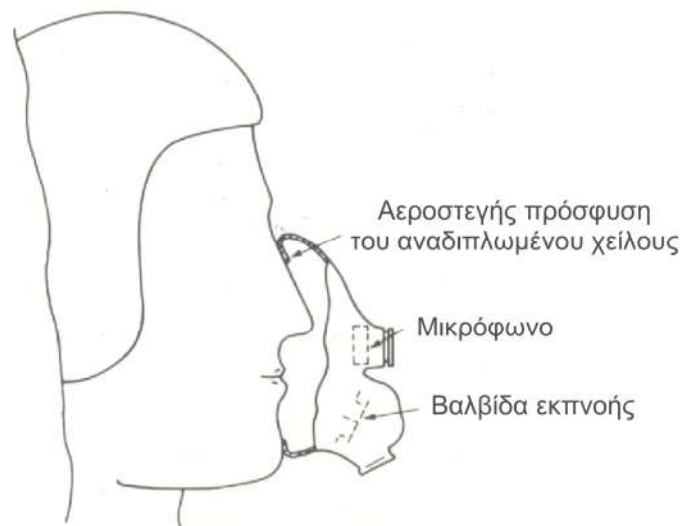
Εικόνα 7-5 Τυπική μάσκα σε διατομή
